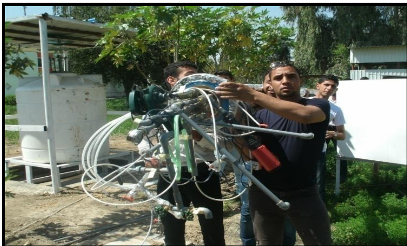
شكل (2): المعدات اللازمة للجهاز للتركيب على فوهة البئر الملوثة من تصميم الباحث
