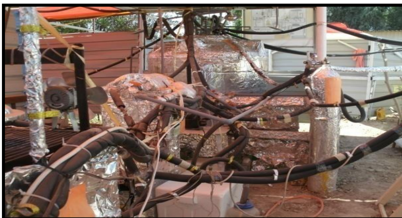
شكل (3): تركيب المعدات بشكل كامل فوق فوهة البئر وربط الوصلات الكهربائية استعداداً لعملية الاختبار
